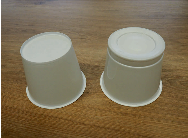
Bild 6. An der Seitenwand zwar etwas dünner, ist der thermogeformte Becher (rechts) wegen der Masseanhäufungen an Boden und Siegelrand doch schwerer als der spritzgeprägte (links). © Hanser/C. Doriati
