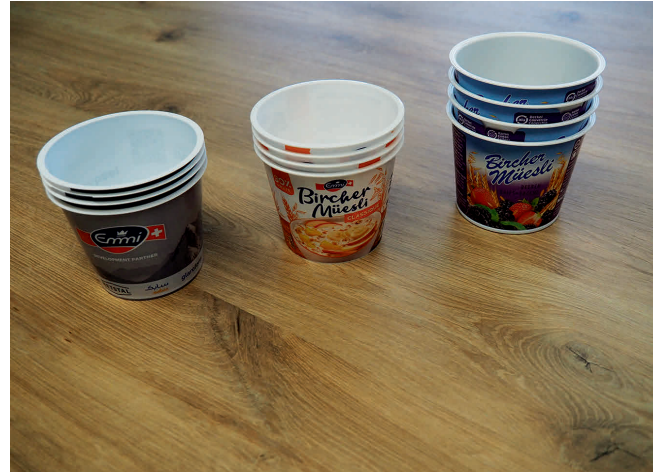
Bild 7. Bei gleicher Becherzahl macht die Karton-Banderole die Stapelhöhe des Tiefziehprodukts (rechts) deutlich höher als die der ICM- (links) und Spritzgießvariante (Mitte). © Hanser/C. Doriati
