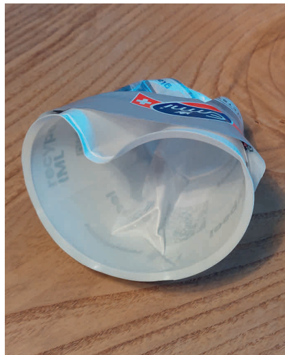
Bild 8. Das Label löst sich – hier ein Selbstversuch – im mechanischen Recyclingprozess problemlos ab. © Hanser/C. Doriati
