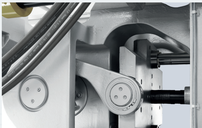
Elektrischer Auswerfer mit präziser und dynamischer Hebel-Betätigung
